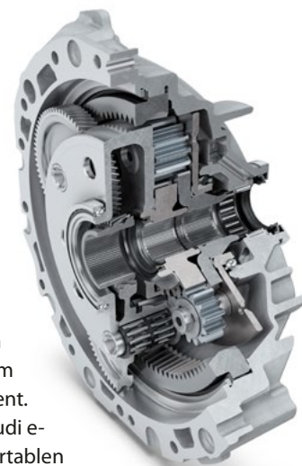
Das Getriebe in koaxialer Anordnung aus dem Hause Schaeffler treibt die Hinterachse des Audi e-trons an. Es zeichnet sich durch einen hoch integrierten gestuften Planetenradsatz in Kombination mit einem Stirnraddifferential aus. Dadurch ergibt sich eine besonders gute Bauraumnutzung im Fahrzeug.
